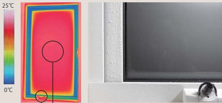
[結露画像条件] 室外温度:0°C / 室内温度:20°C / 相対湿度:60%
